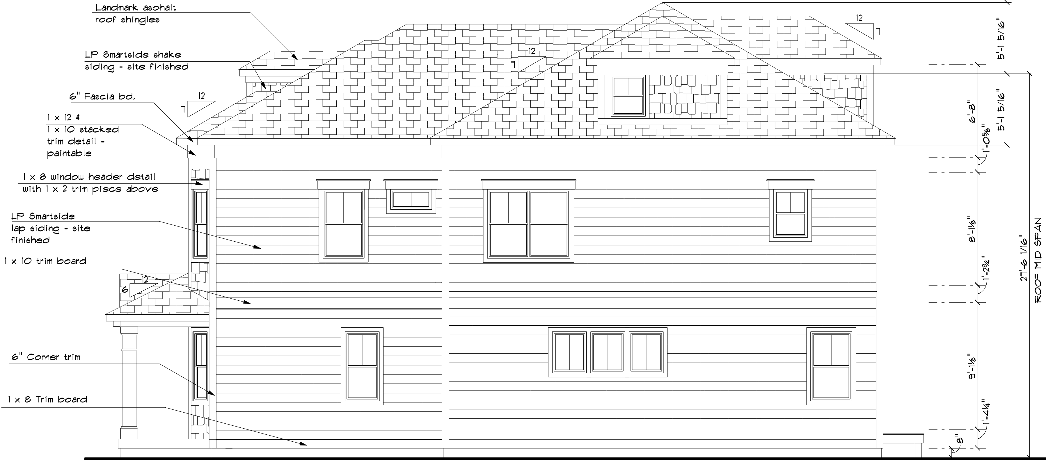
RIGHT ELEVATION SCALE: 1/4" = 1'-0"
